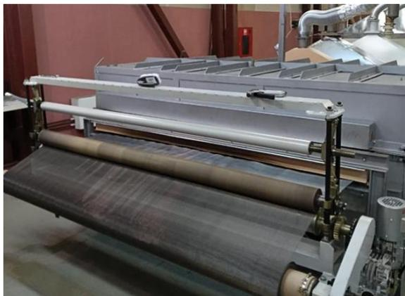
Была запущена дополнительная производственная линия по выпуску нанесённых сетчатых катализаторов, используемых в азотной промышленности и экологии. Возможности новой линии позволяют обрабатывать полосу шириной до двух метров в отличие полосы метровой ширины, выпускаемой ранее. Это обеспечит производство катализаторной сетки с учётом
